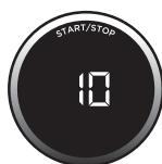
Passe para o modo manual para controlar totalmente a velocidade de liquidificação e as texturas. Prima MANUAL, rode o botão rotativo para selecionar a velocidade desejada e depois prima START/STOP (Iniciar/parar). Quando selecionada, cada velocidade funciona continuamente durante 60 segundos. Prima novamente o botão rotativo para parar o programa antes do fim. Os programas manuais não funcionam em conjunto com os programas BlendSense ou Modo de Processamento.
