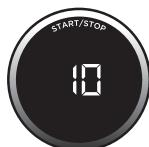
Met de handmatige stand hebt u zelf maximale controle over de snelheid waarmee u blendt en de textuur die u krijgt. Druk op MANUAL (handmatig), draai aan de draaiknop om de gewenste snelheid te selecteren en druk op START/STOP. Na selectie loopt elke snelheid 60 seconden zonder onderbreking. Druk nog een keer op de draaiknop als u een programma eerder wilt stoppen. Handmatige programma's werken niet samen met het BlendSense-programma of automatische programma's.
