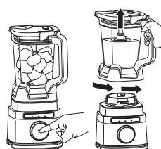
**6b** Se usar um programa de Modo de Processamento, selecione **MODE (Modo)**, e depois use o botão rotativo para selecionar o programa desejado. Para começar, prima o botão rotativo. O programa parará automaticamente quando estiver concluído. Para parar o aparelho a qualquer altura, prima o botão rotativo novamente.
