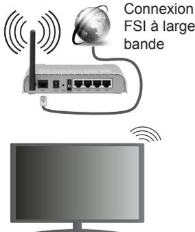
Un routeur sans fil-N (IEEE 802.11a/b/g/n) avec des bandes simultanées de 2,4 et 5 GHz est conçu pour augmenter la bande passante. Ces fonctions sont optimisées pour une transmission vidéo en HD plus claire et plus rapide et un transfert de fichiers et jeux sans fil faciles.
