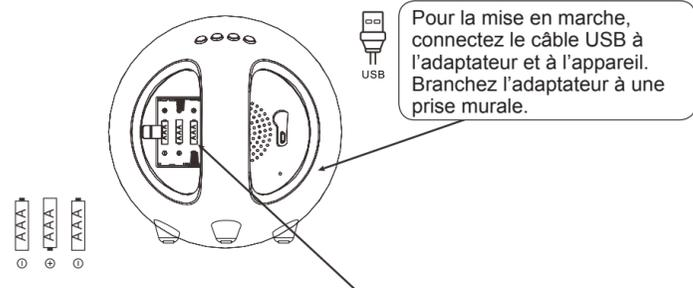
Utilisez des piles comme sauvegarde de courant. En cas de coupure d'électricité, cela sera utilisé pour sauvegarder les réglages.
