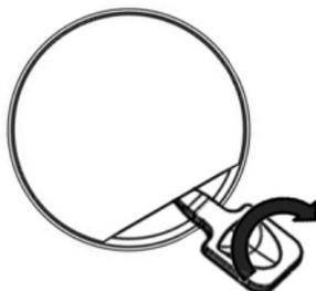
4. Inserire la batteria (modello: CR2032) avendo cura di posizionare il polo positivo (+) verso l'alto, in direzione del vano batteria.
