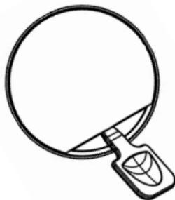
3. Gire suavemente la herramienta de apertura para abrir la cubierta. Cuando la cubierta empiece a abrirse, utilice la herramienta alrededor de la cubierta hasta que se despegue totalmente.
