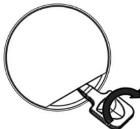
4. Inserte la pila (modelo: CR2032) con el polo positivo (+) orientado hacia arriba en el compartimiento de la pila.
