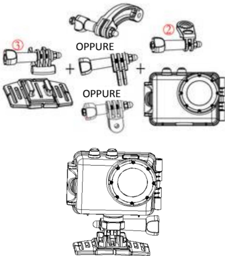
4. Dopo aver fissato la fotocamera al supporto, utilizzare la cinghia in dotazione o l'autoadesivo per attaccarla al casco.
