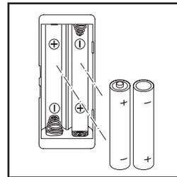
Bei einem Stromausfall läuft das Gerät mit der Batteriepufferung weiter. Hierzu verwendet das Gerät zwei Batterien (AAA). Das Gerät erinnert sich an die Zeit, zeigt diese aber nicht an.
