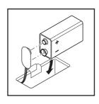
En cas de panne secteur, l'appareil peut compter sur des piles comme source d'alimentation auxiliaire. À cet effet, l'appareil utilise une pile (9V). L'appareil se souvient de l'heure mais ne l'affiche pas.
