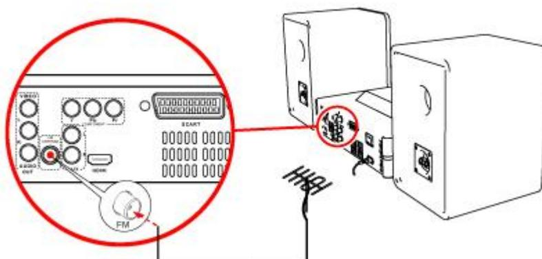
Insérez l'antenne aérienne en le connection .
