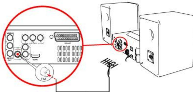
Stecken Sie eine FM-Antenne oder ein geeignetes Kabel in den -Anschluss.
