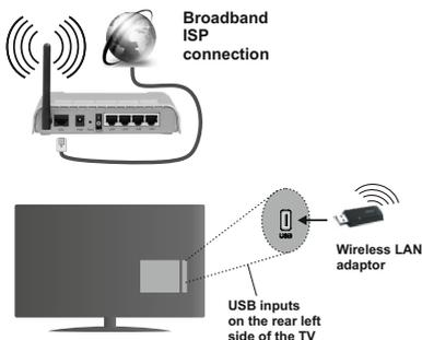
Un router inalámbrico (IEEE 802.11a/b/g/n) con banda simultánea de 2,4 y 5GHz diseñado para aumentar el ancho de banda. Están optimizados para hacer más suave y más rápido streaming de vídeo de alta definición, transferencias de archivos y juegos inalámbricos.
