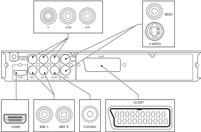
Das Gerät verfügt über verschiedene Optionen für einen dauerhaften Anschluss der Peripherieausrüstung. Geeignete Kabel erhalten Sie bei Ihrem Vertriebspartner.
